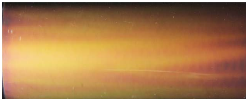
Рис.1. Фотография конвективных структур в пороге. Скорость вращения полости f_{\text{rot}} = 2 об/с; частота угловых колебаний f_{\text{lib}} = 6 Гц, амплитуда модуляции скорости вращения \varepsilon = 0.25
