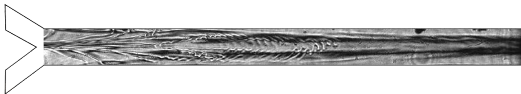
Рис. 2. Интерферограмма, демонстрирующая распределение вещества вдоль канала при v = 0.35 мм/с, \delta = 1.25 , \Delta\rho = 0.015 г/см 3 .
