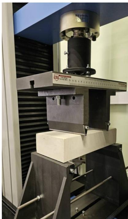
Рисунок 1 — Фотография испытания образца в виде прямоугольной балки на четырёхточечный изгиб
