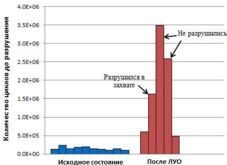
Рис. 3. – Диаграмма результатов усталостных испытаний
