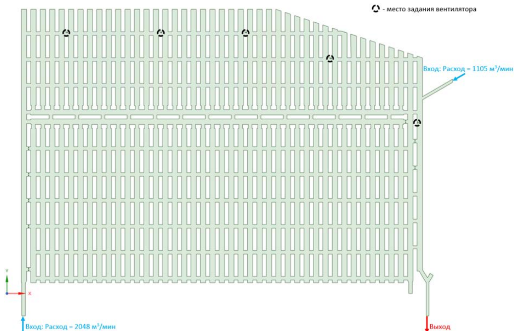
Рис. 1. Геометрическая модель одной из добычных панелей шахты, разработанная в программном комплексе Ansys
