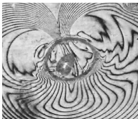
Рис 1. Интерферограмма поля концентрации при диффузии уксусной кислоты C_0=1.74 моль/л в каплю воды с D_0=6.1 мм из смеси бензолов в горизонтальном слое. Время с момента создания капли t=300 с
