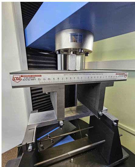
Рисунок — Фотографии испытания образца в виде прямоугольной балки
