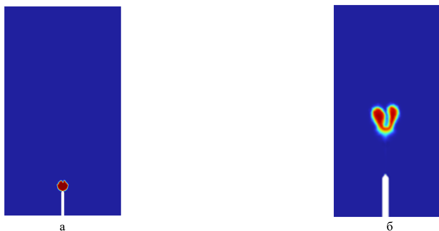
Рис. 1. – Формирование «вязких пальцев»; а – момент отрыва капли от капилляра, б – через 5 минут после отрыва.
