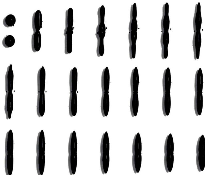
Рис. 1. Монослой капель феррожидкости в последовательные моменты времени после приложения однородного магнитного поля.
