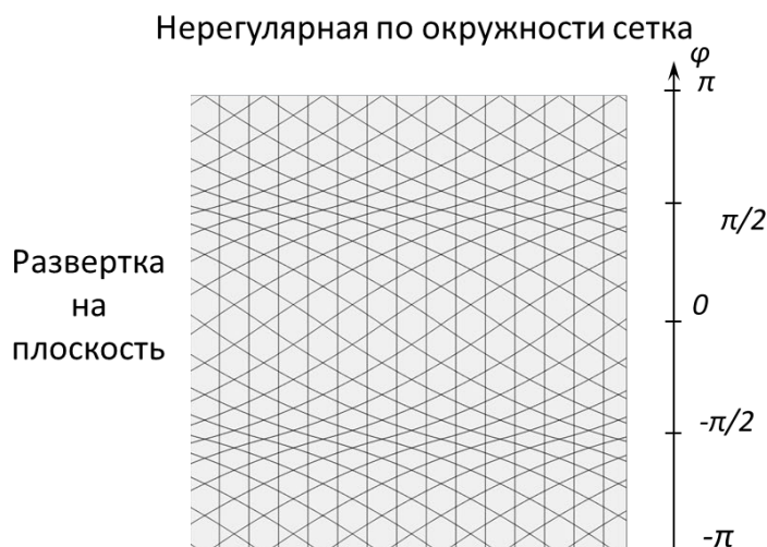
Рис. 2. – Сетчатая структура отсека фюзеляжа, нерегулярного по окружности
