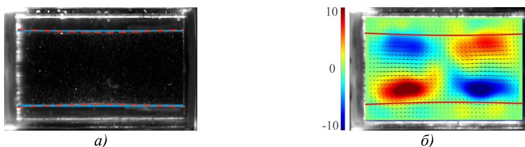
Рис. 1. Форма границы раздела при \varepsilon = 0.09 в фазе либраций \Omega_{lib}t = 0 : а) фото эксперимента; б) мгновенное поле скорости
