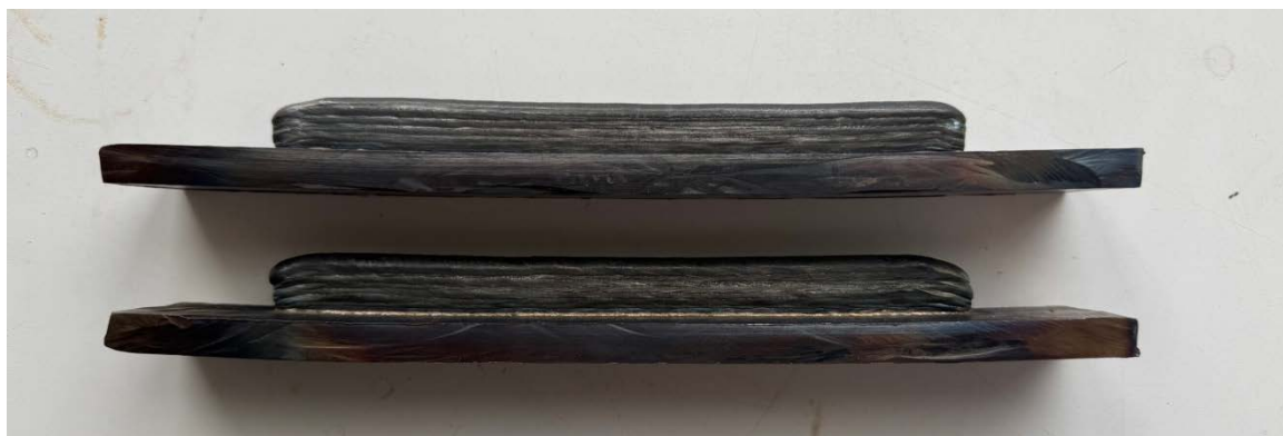
Рис. 1. – Образцы «Ребро на основании», наплавленные проволокой Inconel 625 с применением технологических режимов А (верхний) и Б (нижний).
