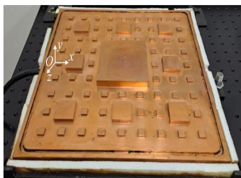
Рис. 1. Сложный рельеф дна (а) и зависимость числа Нуссельта от числа Рэлея для различного рельефа дна и рабочих жидкостей (б).
