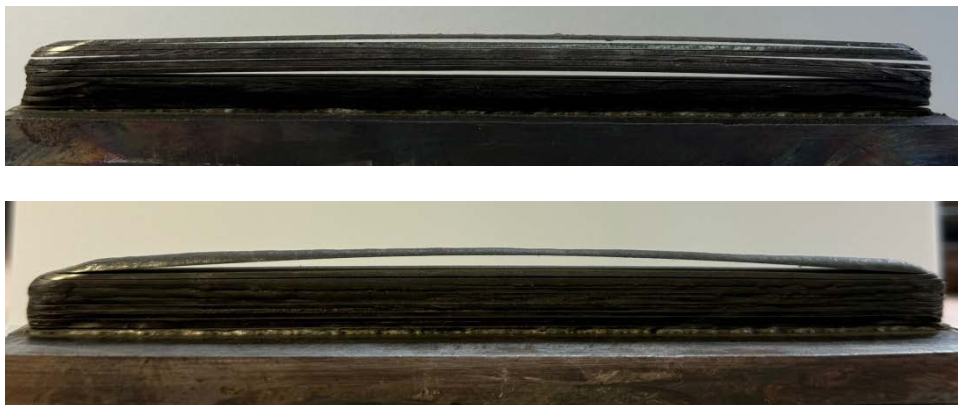
Рис. 2. – Образцы А (верхний) и Б (нижний) после послойного разрезания
