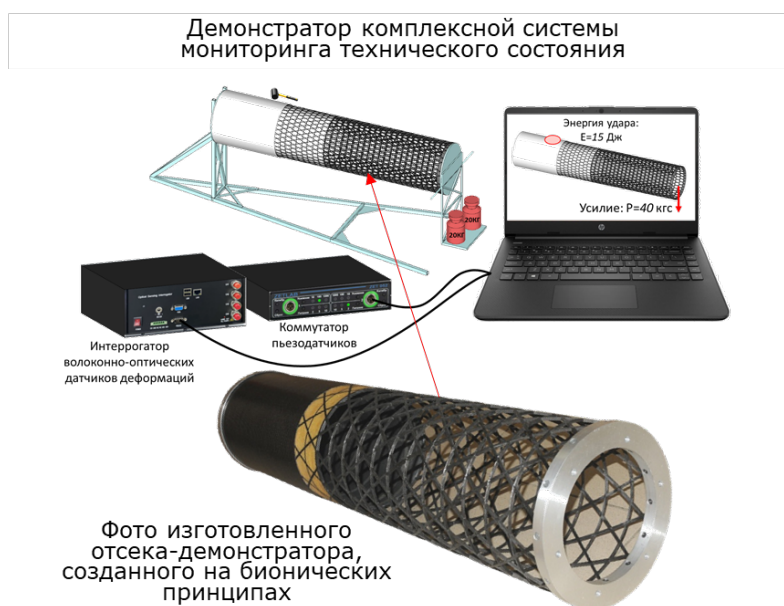
Рис. 1. – Схема демонстратора комплексной встроенной системы мониторинга технического состояния и фото изготовленной конструкции отсека
